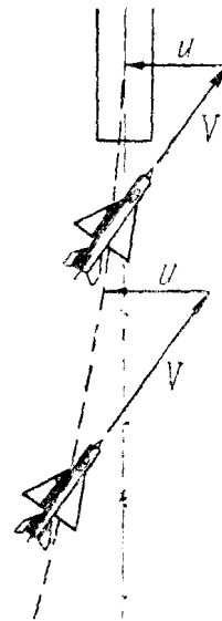
Рис. 8.17: Парирование увеличения угла сноса заходом под углом к ВПП
