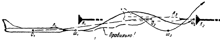
Рис. 9.11: Траектории центра тяжести самолета и конца штанги при различных способах пристраивания к конусу
